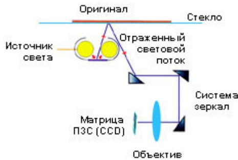
**Рисунок 12. Принцип работы сканера**
